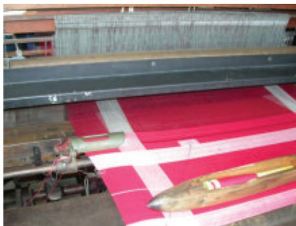
Pormenor de um tear com os fios da teia montados, a trama, a naveta ou lançadeira, etc.
